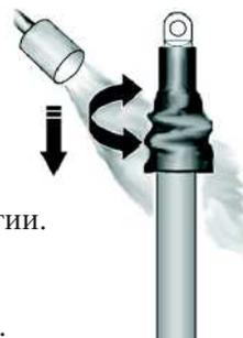
**8. Надвиньте** концевую манжету на цилиндрическую часть наконечника (до перехода в контактную часть) и **усадите** её, начиная прогрев от контактной части наконечника.
