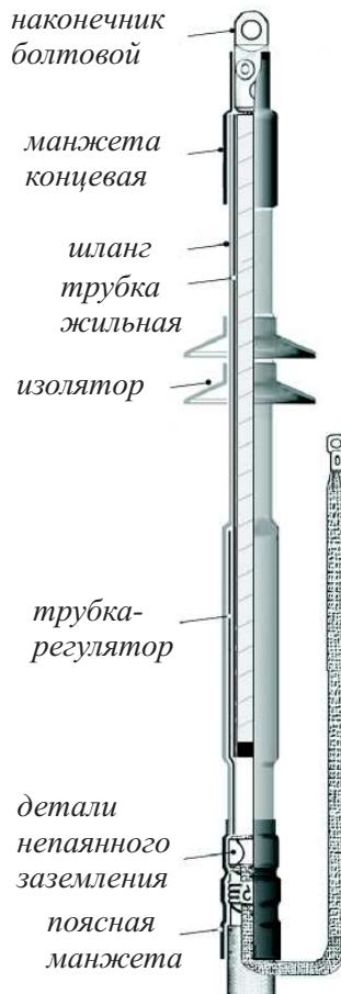
**Допустимая** разность уровня при установке муфты на нижнем конце кабеля - 25 метров
